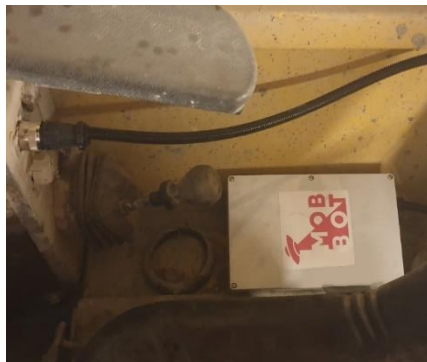
Boîte Mobbot connectée à la machine Meyco ME3.
